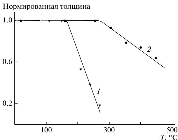
**Рис. 3.** Изменение толщины пленок ПГФП в зависимости от температуры прогрева в вакууме. Пленки нанесены при 20 (1) и 150 мкА/см<sup>2</sup> (2); начальная толщина пленки 170 и 970 нм.
